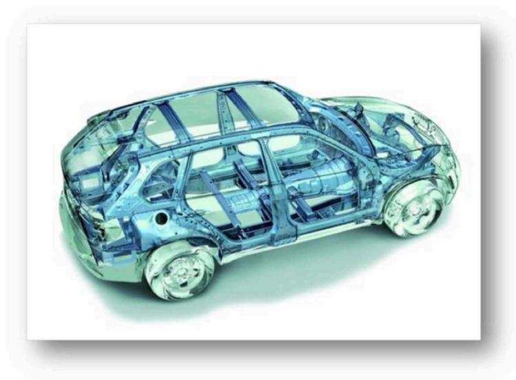
Abbildung 2.6: Einsatz hochfester Stähle im Automobilbau zur weiteren Gewichtsreduzierung.
