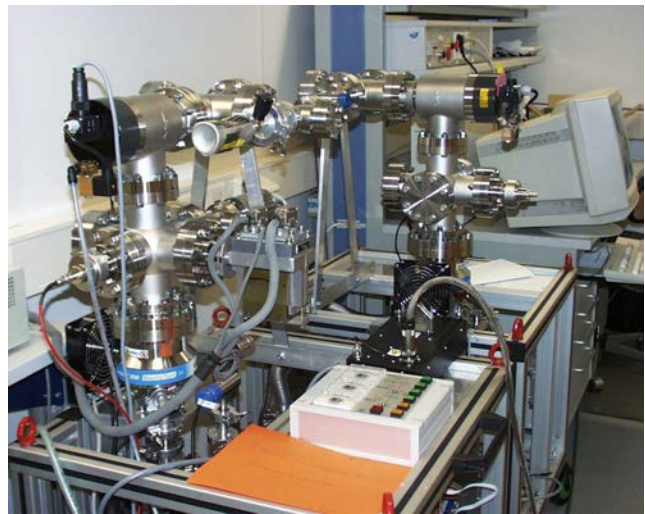
Abbildung 100: Von der Gruppe Mechanik konstruierte und gebaute mobile Vakuumpumpstände.
