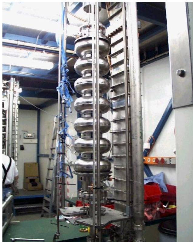
Abbildung 108: Superstruktur Typ 2 bei der Testmontage für den vertikalen Einsatz.
