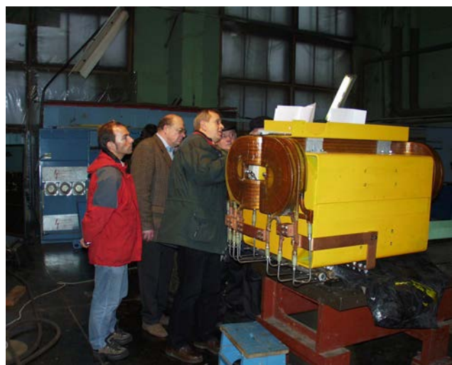
Abbildung 131: Dipolmagnet Typ BP (hergestellt aus altem Typ BT).
