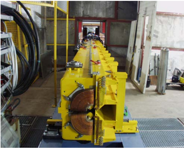
Abbildung 132: Montierter Halbquadrupol NL.
