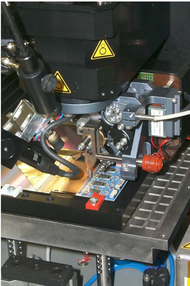
Abbildung 124: Bondautomat Delvotec 6400 im Einsatz beim Zeus-MVD.
