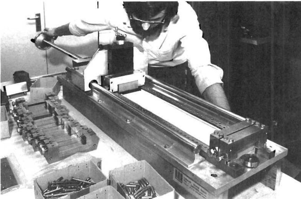
Abb. 9.3: Die Maschine zum Verkleben der Magnete.
