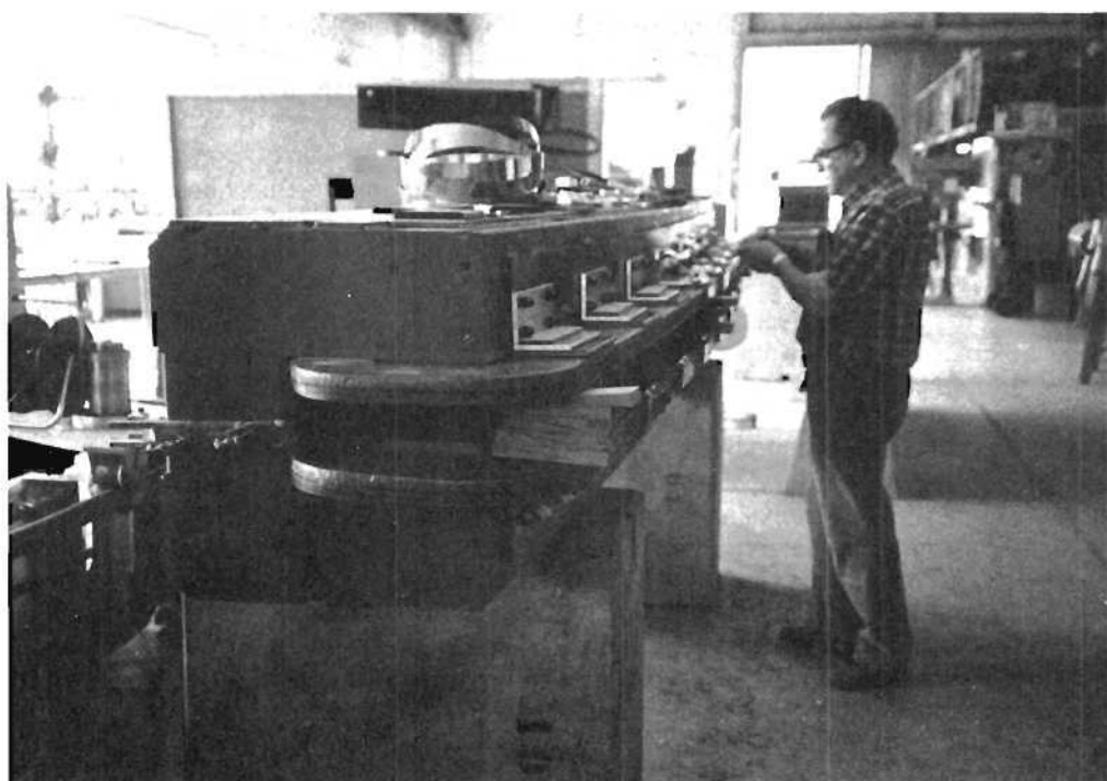
Abb. 16.1: Prototyp eines Dipolmagneten für das neue Elektron/Positron-Synchrotron DESY II.
