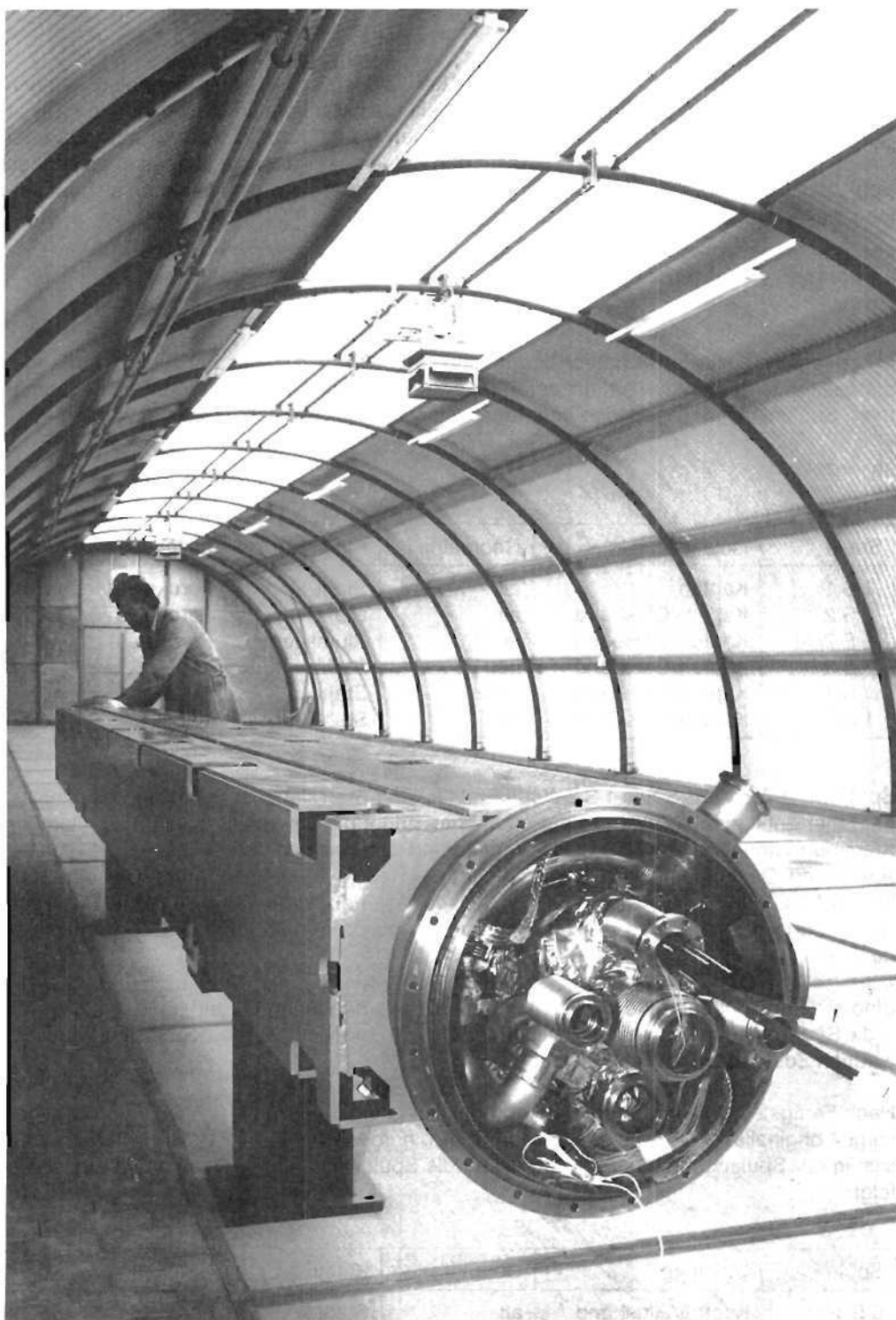
Abb. 22.2: Der erste supraleitende Dipol-Prototyp für den HERA-Protonenring war am 3. November 1983 fertiggestellt.
