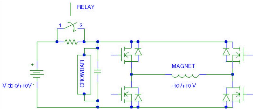
Figure 5.3.- Module d.c./a.c.
