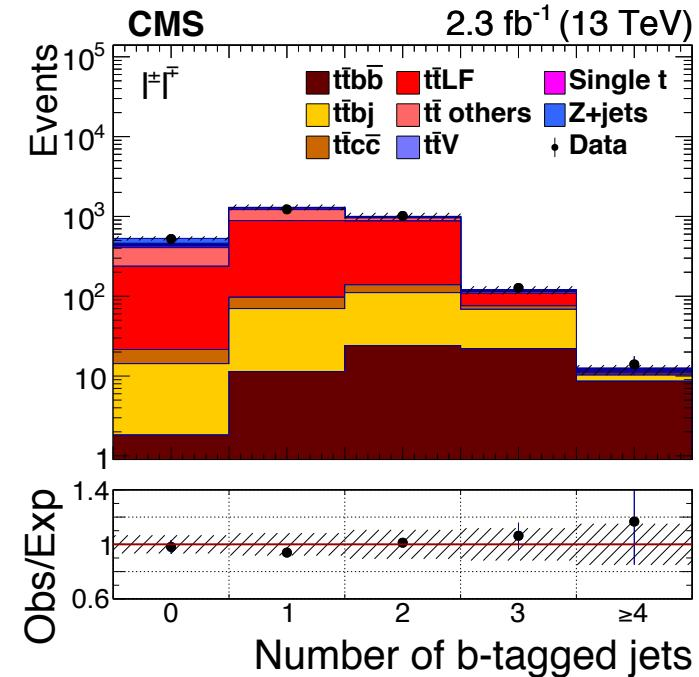
CMS:  $\sigma_{ttbb}/\sigma_{ttj} = 0.022 \pm 0.003_{\text{stat}} \pm 0.006_{\text{syst}}$
