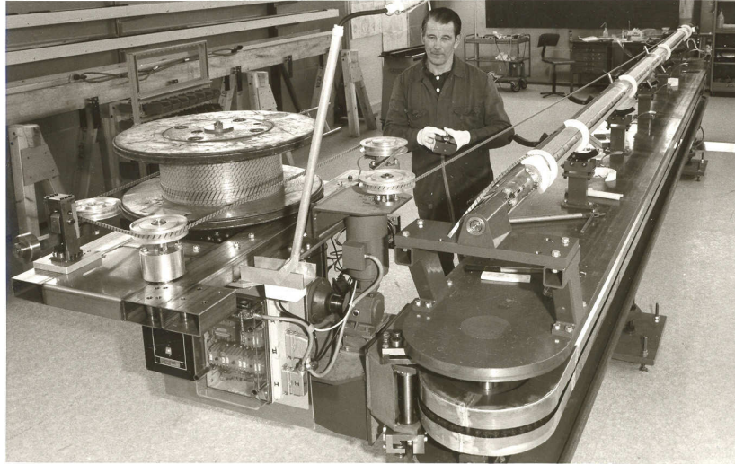
Abbildung 9.6 Eine am DESY entworfene Maschine für das Wickeln von 6 m langen supraleitenden Dipolspulen (DESY-Archiv).
