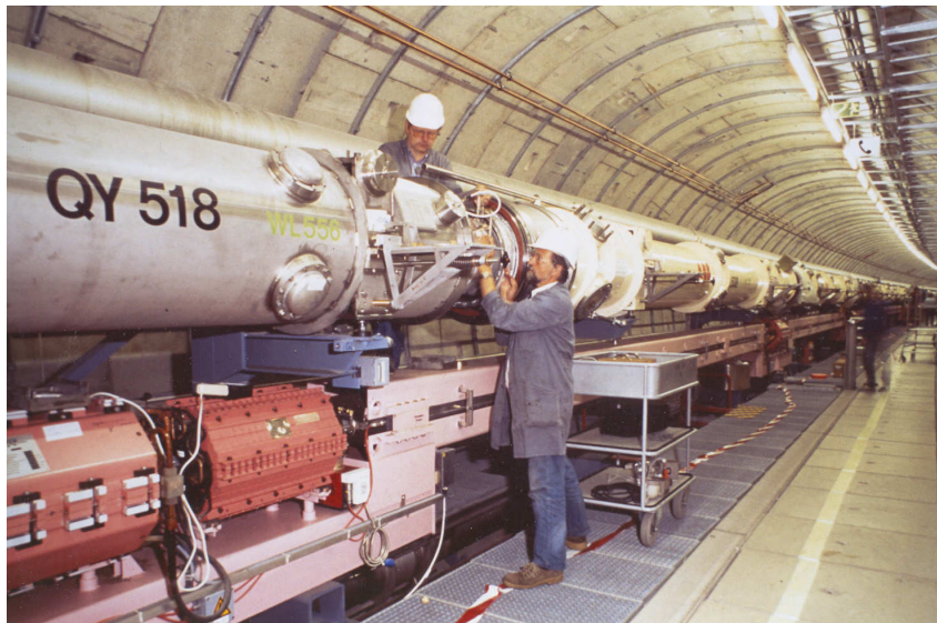
Abbildung 9.8 Blick in den HERA-Tunnel. Oben die supraleitenden Magnete des Protonenrings in ihren Kryostaten, darunter der Elektronenring (DESY-Archiv).
