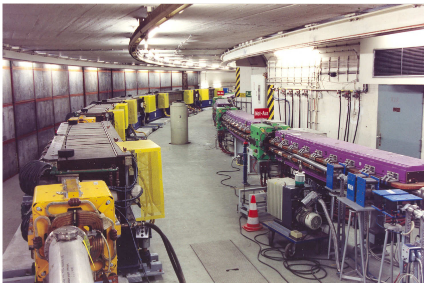
Abbildung 9.12 Die zwei neuen HERA-Injektor-Synchrotrons im Ringtunnel des ursprünglichen Synchrotrons: Rechts DESY II für Elektronen und Positronen, links DESY III für Protonen (DESY-Archiv).
