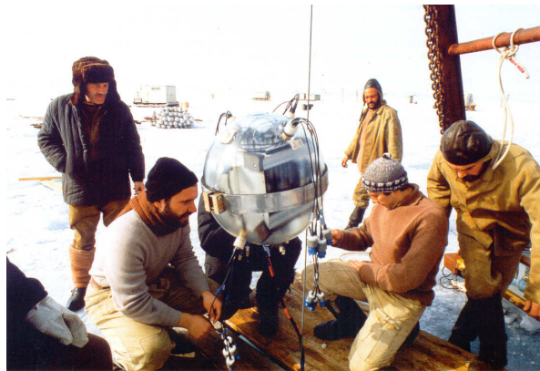
Abbildung 14.3 Russische und Zeuthener Wissenschaftler auf dem zugefrorenen Baikalsee. Sie präparieren eine der ein Photosensor-Modul umschließenden druckfesten Glaskugeln, bevor sie in den See hinuntergelassen wird (DESY-Archiv).
