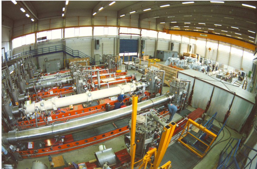
Abbildung 9.7 Blick durch ein Weitwinkelobjektiv in die Magnetmesshalle mit Dipol- und Quadrupolmagneten auf den Testständen (DESY-Archiv).
