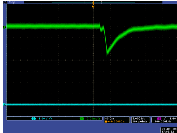
Abbildung 29: Blaue LED des Herstellers Kingbright (Typ L-53MBDL) im Schaltsystem des LED-Driver-Boards (Zeitachse: 40\text{ns}/\text{div} . Intensität: 2\text{mV}/\text{div} .).
