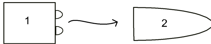
Abbildung 36: Funktionsskizze zum experimentellen Aufbau zur Maximierung des Spannungsflusses des LED-Driver-Boards mit einem Photomultiplier. Das LED-Driver-Board System (1) sendet beim Betrieb zweier LED's Licht aus, das vom Photomultiplier detektiert wird (2). Beide Komponenten dieses Aufbaus befinden sich in der lichtundurchlässigen „Blackbox“.
