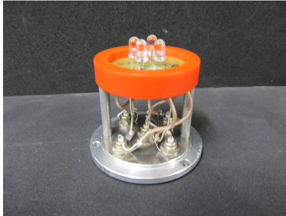
Abbildung 12: Gesamtkonstruktion des LED-Driver-Board Systems. Das LED-Driver-Board ist die kreisförmige eingerastete Scheibe auf die die 4 LED's gelötet sind.
