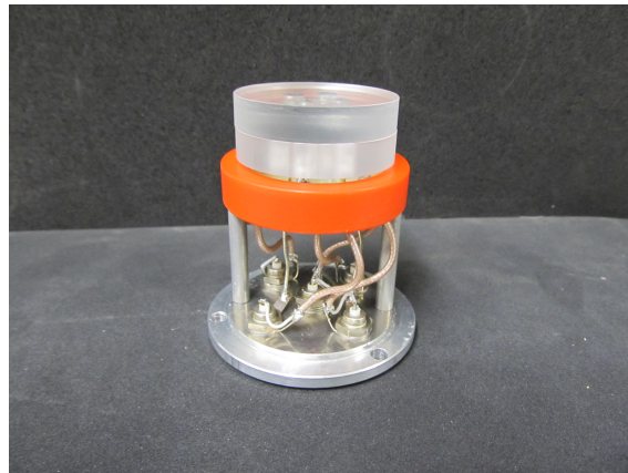
Abbildung 15: LED-Driver-Board System mit dem darauf angebrachten Plexiglasblock.
