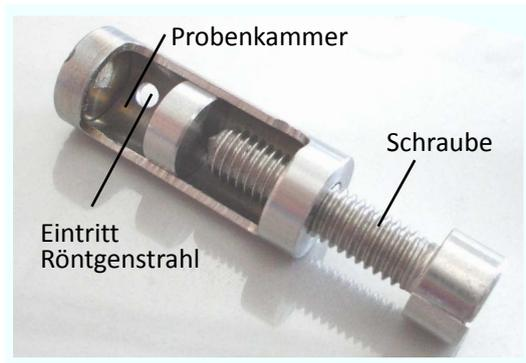
**Abbildung 3.1:** Probenhalter zur Messung der Stickstoffsorption und Röntgenstreuung uniaxial komprimierter Proben.
