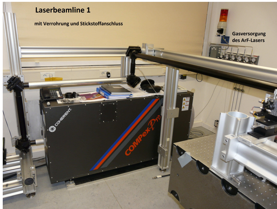
Abbildung 4.3: mechanischer Aufbau Laserbeamline 1 bis Optiktisch mit Gasanschlüssen für ArF-Laser
