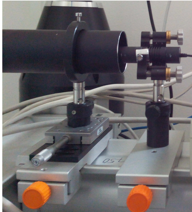
Abbildung 4.5: Justierlaser zur ersten Ausrichtung der Spiegel und des Strahlführungsrohres auf die Laserstrahlachse
