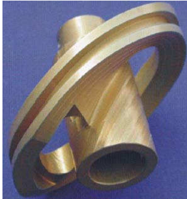
Bild 22: Nutkurvenscheibe zur Umwandlung der rotatorischen in eine geradlinige Bewegung
