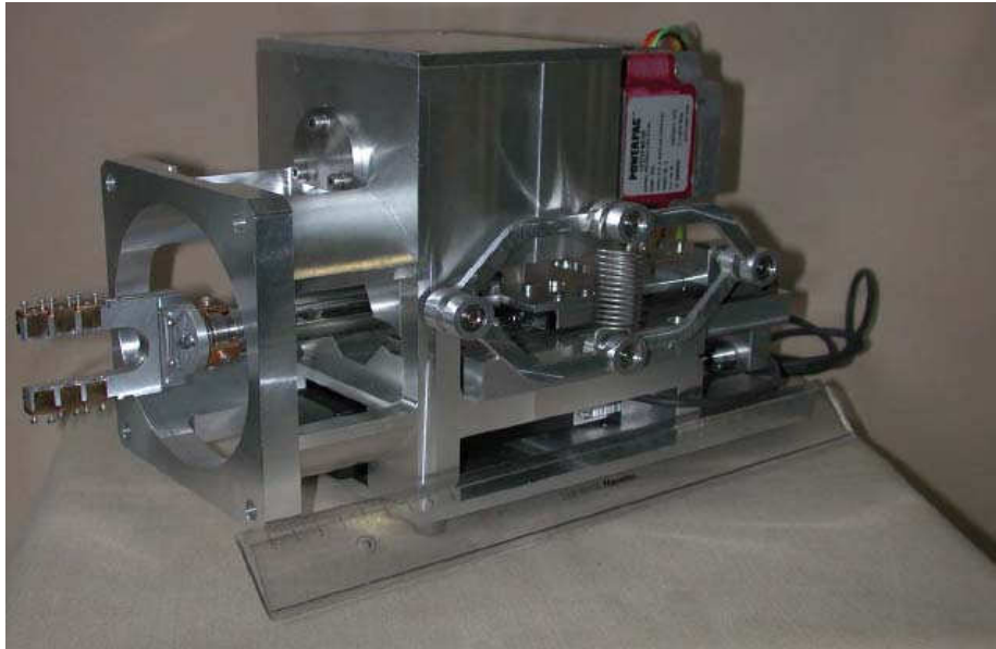
Bild 19: Wirescanner (Abmaße: L x B x H = 320mm x 160mm x 205mm)
