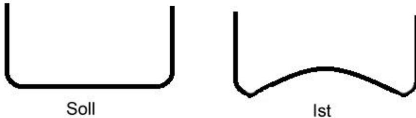
Abbildung 12 – Aufwölbung der Trichterauskleidung (Skizze)
