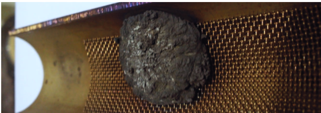
Abb. 21 Lithiumblock nach der Aufheizphase
