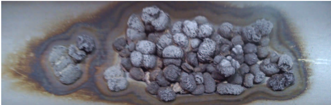
Abb. 16 Lithium in der Halbschale nach dem Aufheizen
