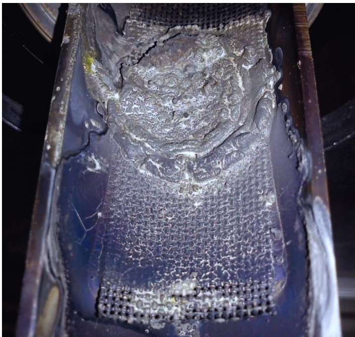
Abb. 22 geschmolzenes Lithium im Gitter verlaufen.
