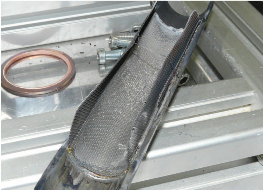
Abb. 27 0,71mm Gitter mit 1,5g Lithium vollständig im Gitter verlaufen
