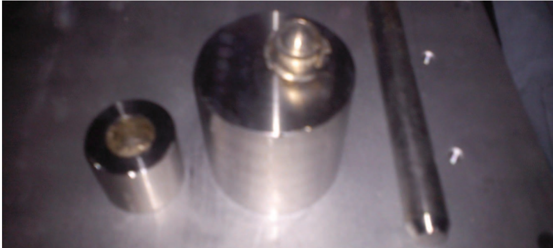
Abb. 19 Form und Stempel zum Komprimieren der Lithiumgranalien, geformtem Block(Mitte)
