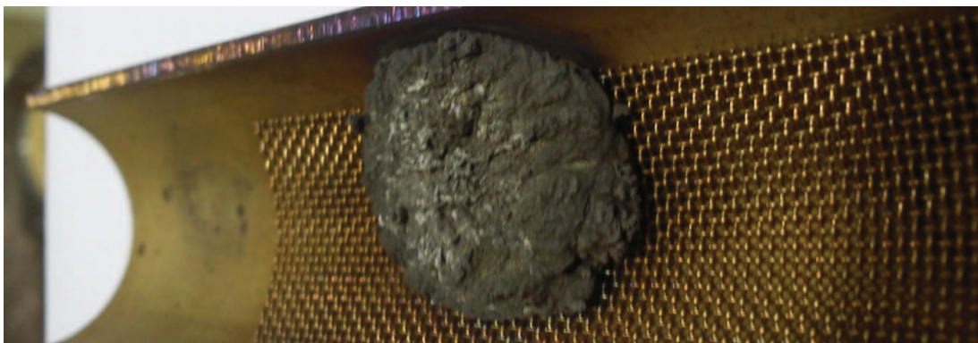
Abb. 21 Lithiumblock nach der Aufheizphase
