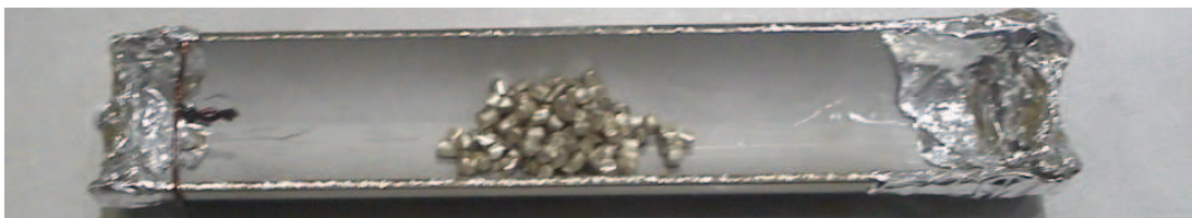
Abb. 15 Lithium in der Halbschale vor dem Aufheizen
