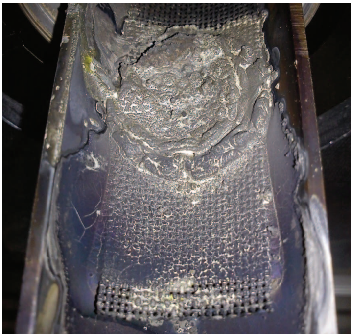
Abb. 22 geschmolzenes Lithium im Gitter verlaufen.
