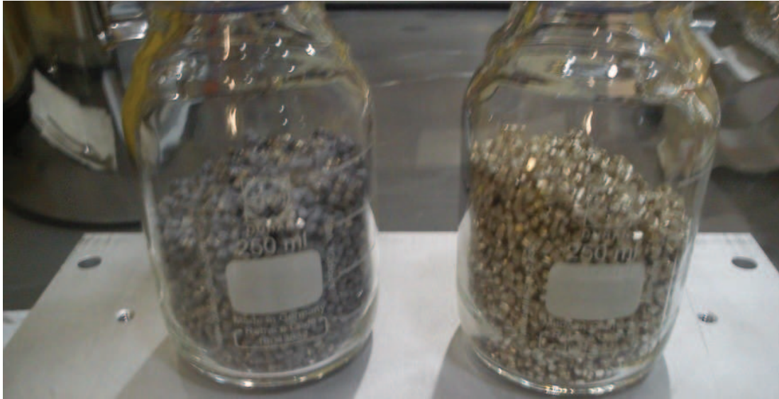
Abb. 14 oxidiertes Lithium(links) im Vergleich zum Ausgangsmaterial(rechts)
