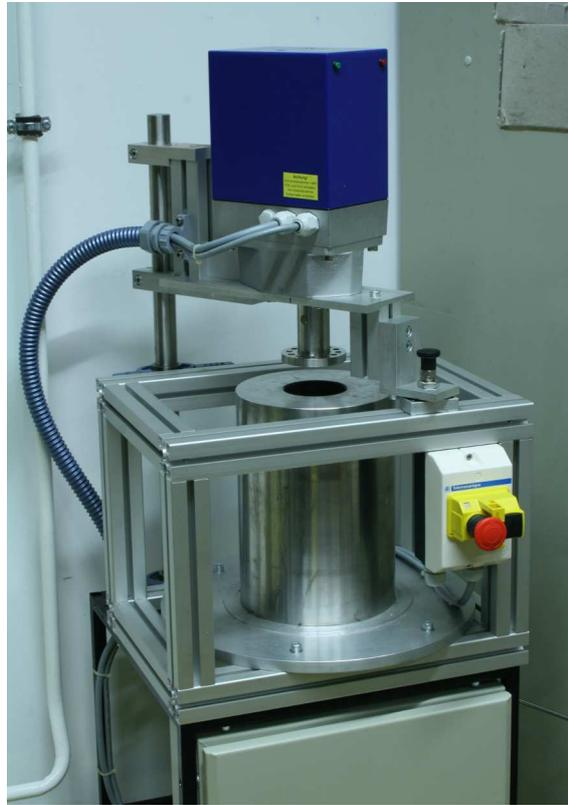
Abbildung E.2: Autoklavengefäß des Gasladers.
