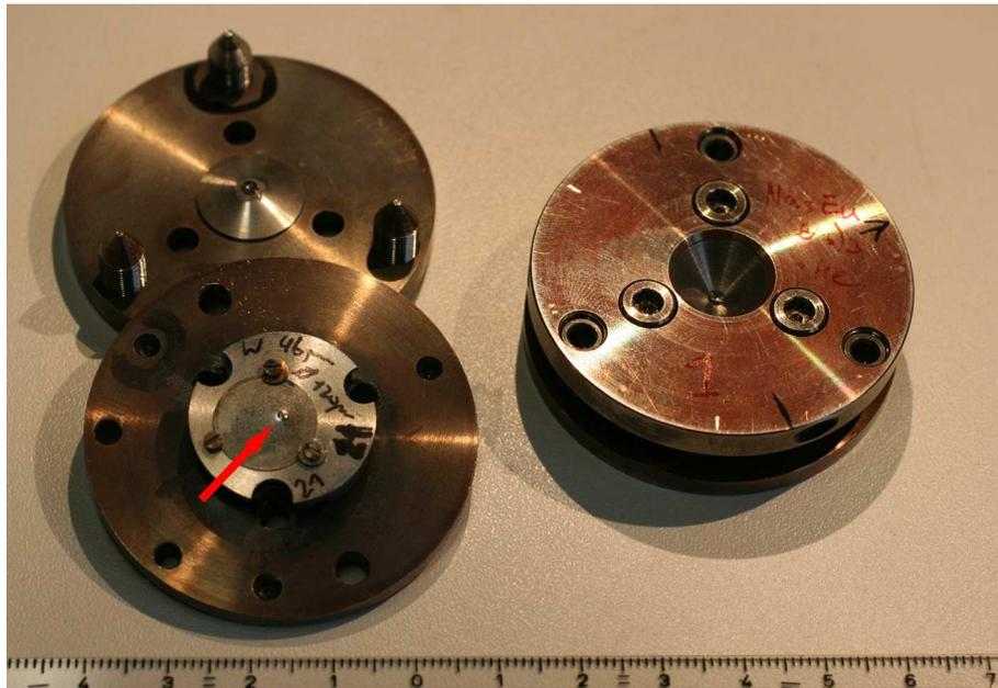
**Abbildung 4.1:** Boehler-Almax Diamantstempelzellen, die linke DAC ist geöffnet, der Abdruck mit der Probenkammer auf dem *gasket* ist mit einem Pfeil gekennzeichnet. Der Durchmesser der DAC ist ca. 50 mm.
