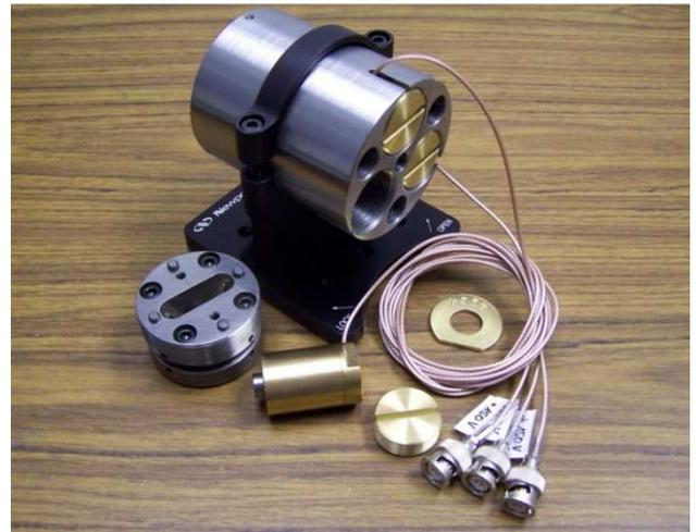
**Abbildung 4.2:** dDAC (Ausführung stauchend)
