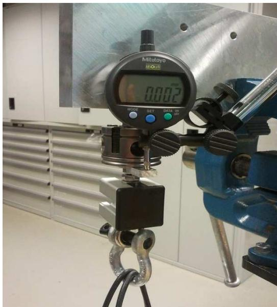
**Abbildung 5.5:** Steifigkeitsmessung; die Messuhr zeigt die Auslenkung infolge von Last
